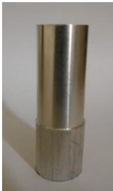
Figura 19 – Peça após a operação de torneamento
